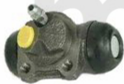
3. 673 398 links/left System: Bendix Ø 17,46 mm 1987>
